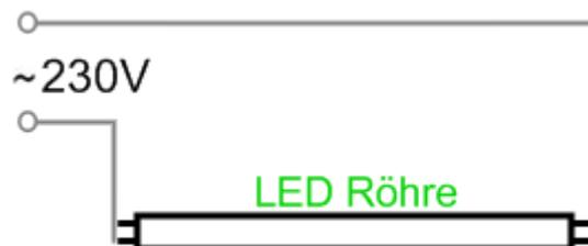
Auf diese Weise werden unsere LED Tubes geschaltet. Vorschaltgerät und Starter sind vollkommen überflüssig. Die LED Röhren werden direkt an die 230V/AC 50Hz Netzspannung angeschlossen. Wegfall des Vorschaltgerätes und Starters ermöglichen 100% Helligkeit sofort nach dem Einschalten zu bekommen, zudem erreicht man noch mehr Stromersparnis, da die Vorschaltgeräte bis zu 7 Watt Energie verbrennen.
